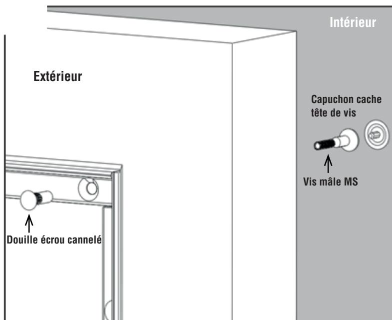
Écrou cannelé à emmancher dans le trou fraisé de la cornière, sur l'extérieur,
